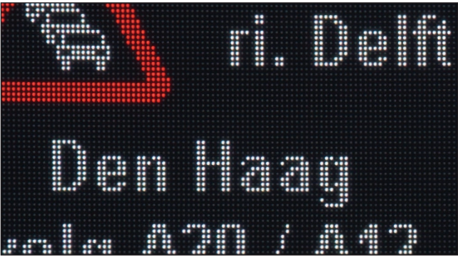
Innovatief 80*80 pixels full colour LED-display (16.000 kleuren) De gepatenteerde technologieën zorgen voor maximaal verbruik van 195 Watt, wat een reductie van 87% is ten opzichte van conventionele LED-displays.
